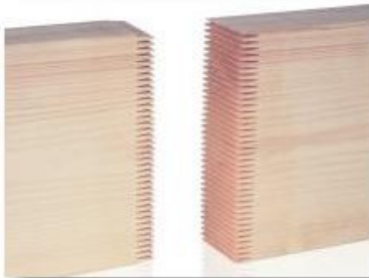
Bild 4: Keilzinkenstoß und Verklebung zu einer Endloslänge
