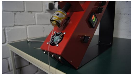
Abb 3: Filament-Extruder (Noztek Pro ABS and PLA Filament Extruder for 3D Printers, Noztek, London, UK) im Labor in Werlte (Klimacenter)
