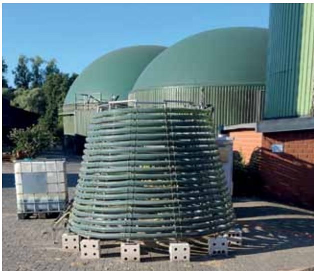
Anfallendes Oberflächenwasser dient zur Kultivierung von Algenbiomasse mittels Röhrenreaktoren.
