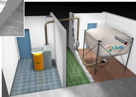
Zuführung mit Druckluft
