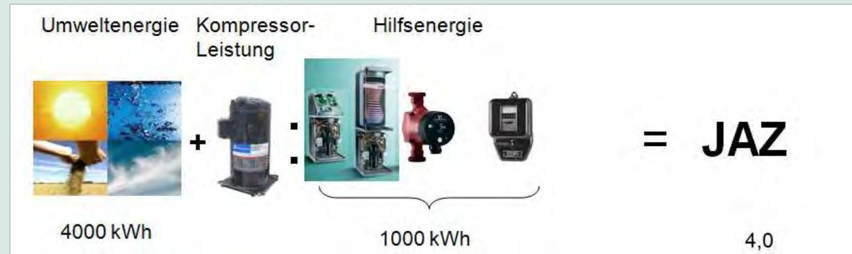
JAZ ist das Verhältnis der abgegebenen Wärmemenge zur eingesetzten Strommenge *einschließlich der Strommenge für den Betrieb von Grundwasser-pumpe oder Soleumwälzpumpe, des Notheizstabes und der Regelung.*
