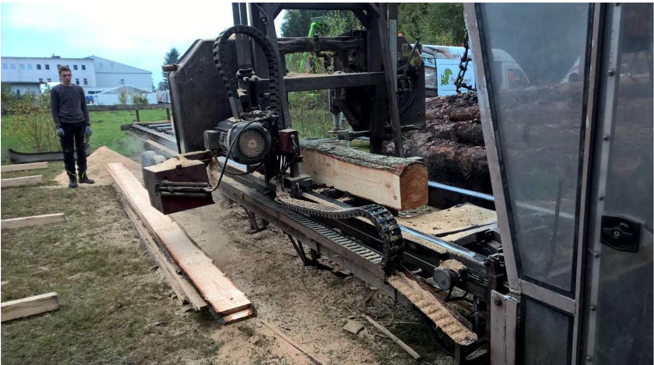
Stationäre Maschinen mit Elektromotor eignen sich hervorragend für Handwerksbetriebe, sie haben geringe Unterhaltskosten und machen wenig Probleme. Wenn man als Lohnsäger aktiv sein will, sollte man schon auf eine mobile Variante zurückgreifen, um damit auch in den Wald zu kommen. Durch hydraulische Helfer am Bett der Maschine kann man die schweren Stämme auch alleine händeln. Hierauf gehe ich aber später ein.
