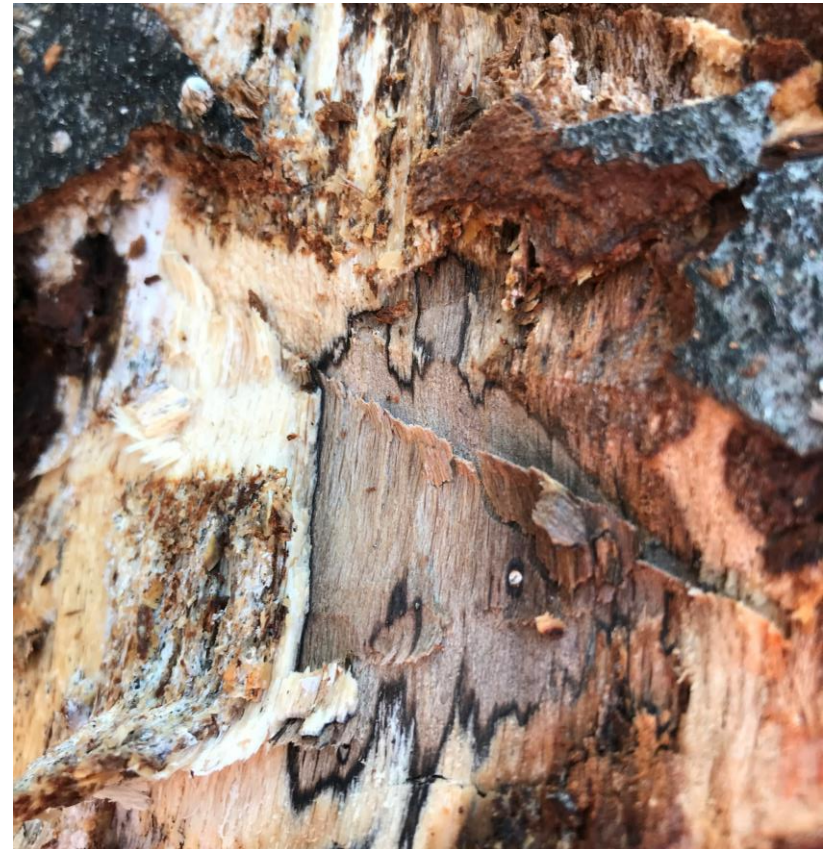
Weißfäule und Vergrauung des Holzkörpers unter Rinde (Axtprobe) (Foto: A. Richardt)
