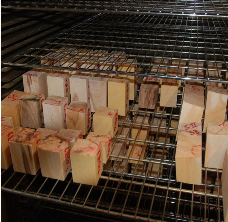
Proben zur Bestimmung des Feuchtgehaltes im Trockenschrank
