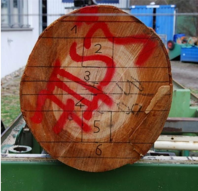
Sägeabschnitt auf der Blockbandsäge
