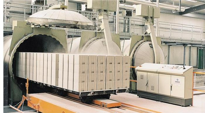
Die Dampfhärtung ist der zentrale Hebel zur klimaneutralen Produktion. Rund 90 Prozent des Energiebedarfs entfällt auf die Dampferzeugung. Die Umstellung auf regenerativen Strom oder grünen Wasserstoff ist technisch möglich, aber laut der Studie mit hohen Investitionskosten verbunden (Quelle: Bundesverband Kalksandsteinindustrie)
