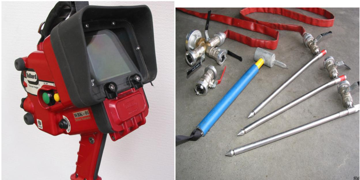
**Bild 17: Thermografiekamera und Fog Nails für eine gezielte Bekämpfung von Hohlraumbränden (mit freundlicher Genehmigung von Herrn Weinhold, Berliner Feuerwehr)**
