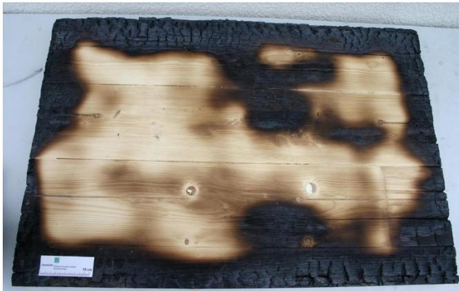
**Bild 16: Oberfläche der geprüften Wand nach dem Entfernen der Schutzschicht**
