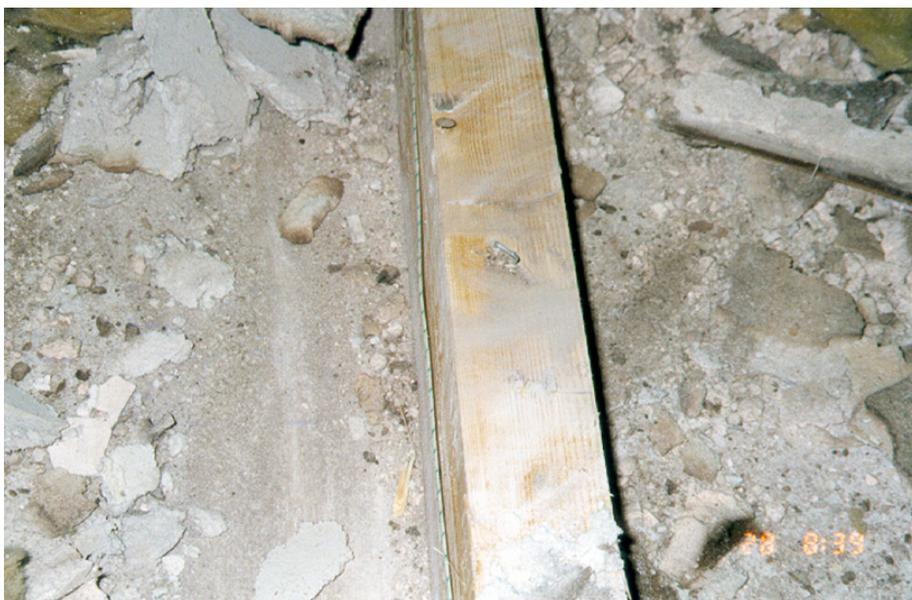
**Bild 9:** Zustand der Holzständer nach einem Brandversuch gemäß [ ]
