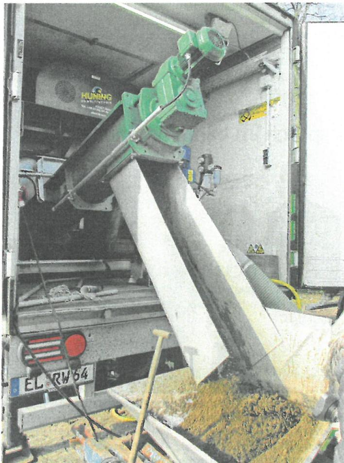
Die RWG Emsland-Süd setzt im Lohnverfahren diese mobile Zentrifuge mit einem Durchsatz von 30 m<sup>3</sup>/h ein.
