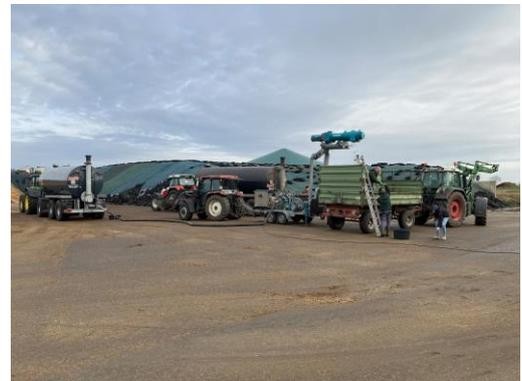
Neben der Beprobung der Fraktionen zur Analyse der Nährstoffgehalte wurden auch die Gewichtsmengen der abseparierten Feststoffe und der Dünnpfase ermittelt. Die Menge des separierten Rohgärrestes wurde über die Addition der Feststoff- und Dünnpfasengewichte ermittelt. Die Versuche wurden von Seiten der LWK durch Hans-Jürgen Technow ausgewertet.
