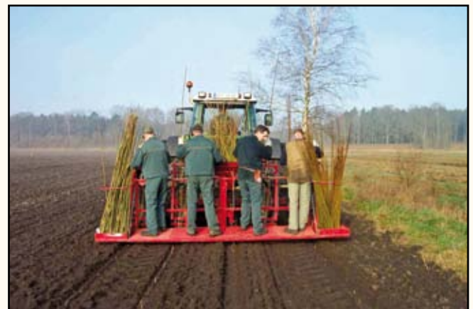
Abbildung 2: Links: Pflanzgerät zur Pappelstecklingspflanzung, Rechts: Ein Step-Planter zur Weidenpflanzung
