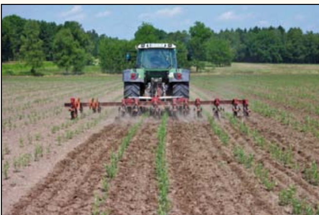
Abbildung 5: Einsatz einer umgebauten Rübenhacke zur mechanischen Unkrautregulierung
