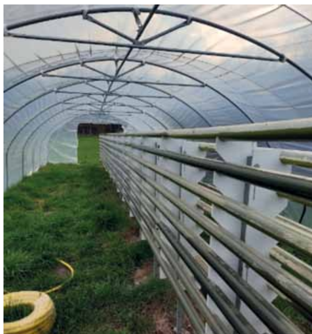
Das anfallende Oberflächenwasser dient zur Kultivierung von Algenbiomasse mittels Röhrenreaktoren.
