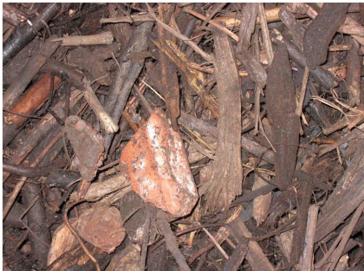
Abbildung 1: Hackschnitzel P16A (a); Hackschnitzel mit hohem Anteil von Überlängen, Feinanteil und Störstoffen (b)
