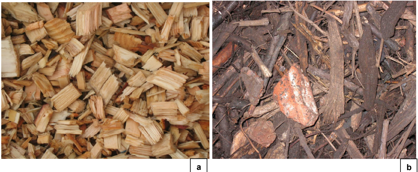
Abbildung 1: Hackschnitzel P16s (a); Hackschnitzel mit hohem Anteil von Überlängen, Feinanteil und Störstoffen (b)
