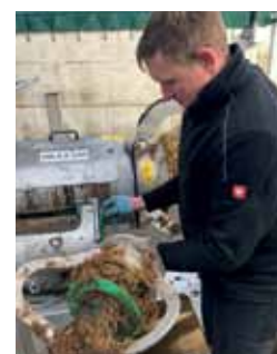
Harald Meyer beim Siebwechsel des Separators
