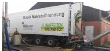
Zentrifuge zur Separation von Gülle und Gärrest, betrieben von RWG und AVD
